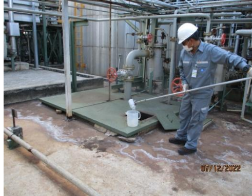
บ่อตรวจสอบคุณภาพน้ำเสียของโรงงาน ก่อนส่งเข้าระบบบำบัดน้ำเสียของโรงงานผลิตสารคาโปแลกติ้ม (Influent)
